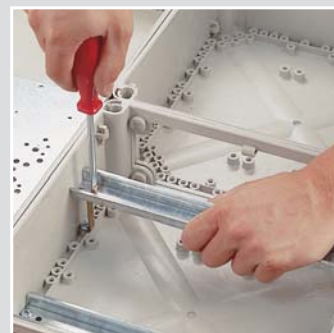
Крепление DIN-рейки на распорках Mi DS 50.
