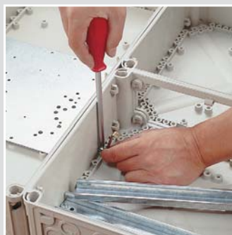
Последующая установка верхнего ребра бокса.
