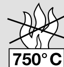
Brennverhalten: Glühdrahtprüfung nach VDE 0471 T 2: 750 °C, schwer entflammbar, selbstverlöschend
