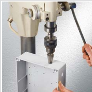
Кабельный ввод может быть просверлен индивидуально.
