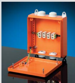
FK 9255 соединительная коробка 1,5-16 мм 2 , Cu ответвительная коробка 1,5-6 мм 2 , Cu
