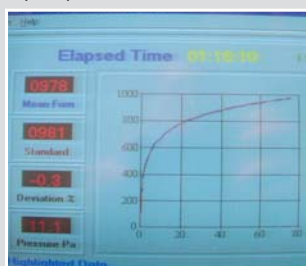
График температурных испытаний в соответствии с DIN 4102
