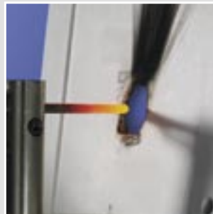
Brennverhalten: Glühdrahtprüfung nach VDE 0471 T 2: 750 °C, schwer entflammbar, selbstverlöschend
