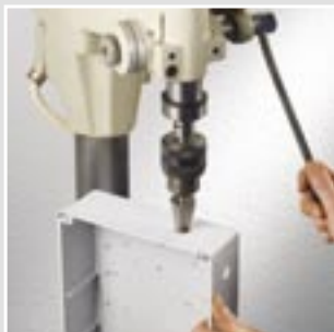
Kabeleinführungen können individuell gebohrt werden.
