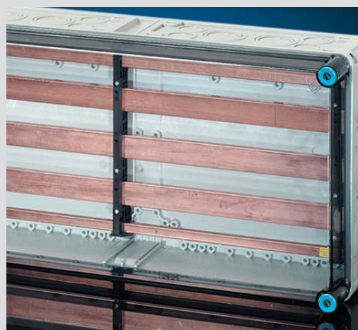
Система токовых шин соответствует нормам по электромагнитной совместимости. Нейтральная шина имеет такую же нагрузочную способность как и внешние шины.
